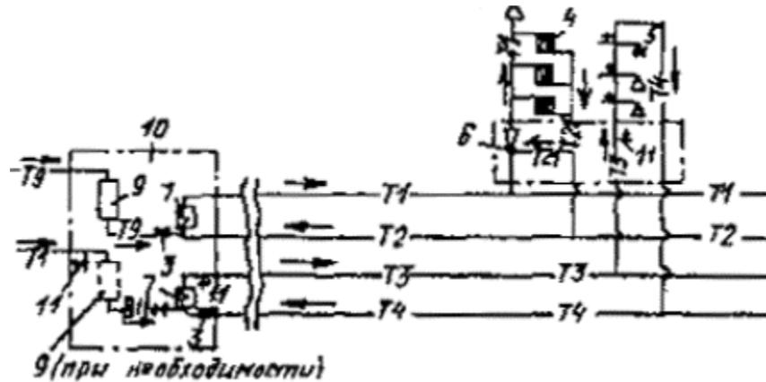
Рис. 3. Схема теплоснабжения с отдельными сетями горячего водоснабжения
